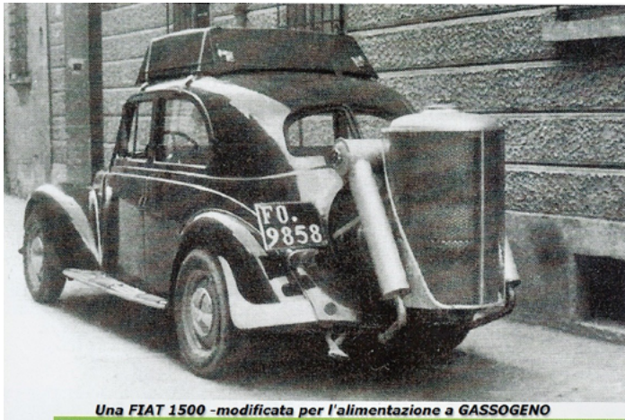
Una FIAT 1500 -modificata per l'alimentazione a GASSOGENO
